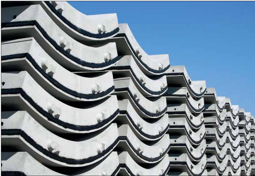
Tunnel-Tübbings auf dem Lagerplatz in Sengenthal. Die Firmengruppe Max Bögl beliefert nach zahlreichen namhaften Tunnelprojekten nun auch die Baustelle für den Brenner Basistunnel in Österreich.
