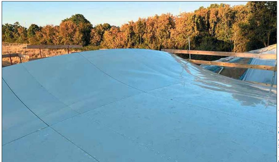
Selbst beim extremen Biegen der alkus® SF Flex entstehen keine Risse, wodurch eine glatte Betonoberfläche erreicht werden kann.
