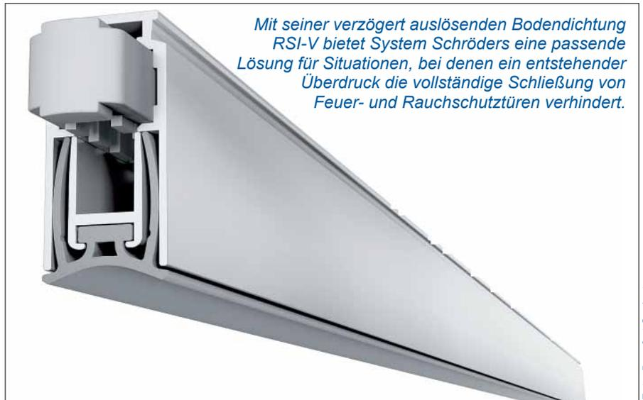
Mit seiner verzögert auslösenden Bodendichtung RSI-V bietet System Schröders eine passende Lösung für Situationen, bei denen ein entstehender Überdruck die vollständige Schließung von Feuer- und Rauchschutztüren verhindert.
