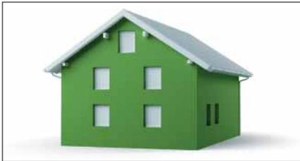
Mit Heck Holzbau A2 ist eine nicht-brennbare WDVS-Ausführung an Ein- und Zweifamilienhäusern bis 7 m in Holzrahmenbauweise möglich.
