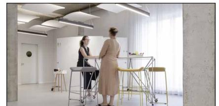
*In allen Besprechungsräumen und in den Büros sind an den Decken Akustik-elemente angebracht. Die Deckensegel passen sich perfekt in die Gestaltung ein. Sie absorbieren den Nachhall deutlich.*
