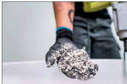
*Der neue Gips-Leichtausgleichsmörtel UZIN SC 904 besitzt eine luftige Konsistenz und lässt sich schnell auf der Baustelle anmischen und verteilen.*
