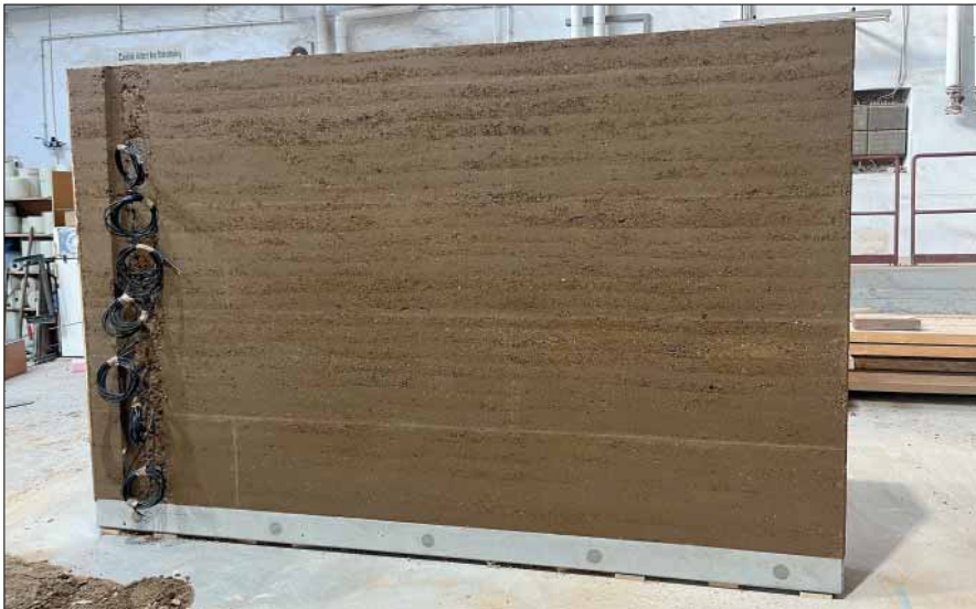
Stampflehmwände werden Maßgenau industriell vorgefertigt und als komplettes Wandelement zur Baustelle transportiert. Für eine Stampflehmwand wird der erdfeuchte aufbereitete Lehm lagenweise in eine Schalung eingebracht und mechanisch verdichtet. Dadurch wird es formstabil und kann sofort entschalt werden.
