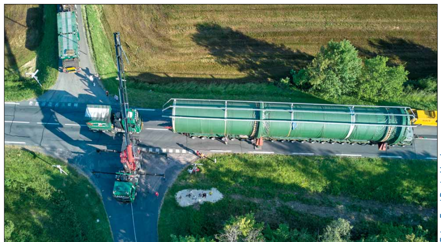
Links oben im Foto zu sehen: Die beiden 3-Achser-Module stehen auf dem Auflieger zur Verlängerung der Transporteinheit bereit.
